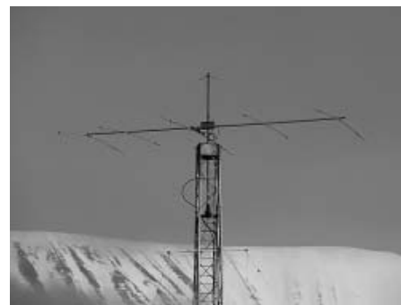
5el. Fritzbeam – tudy „šla“ téměř všechna spojení
