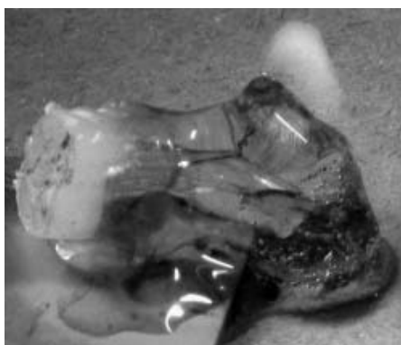
Obr. 6. Co zbude z dielektrika průměru 7,2 mm koaxiálního kabelu R213 po několika vteřinách působení 5 kV
