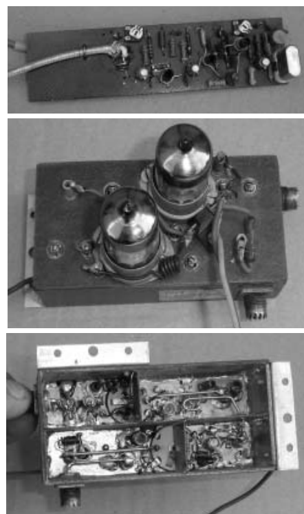
Nahoře: Původní maják OK1KVR/1 po rekonstrukci na pásmo 70 cm. Dole: Později přidaný elektronkový zesilovač k majáku pro 70 cm, konstruovaný již pro síťové napájení.
