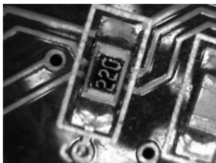
Obr. 5. Zvětšená část desky plošných spojů, osazené součástkami SMD
