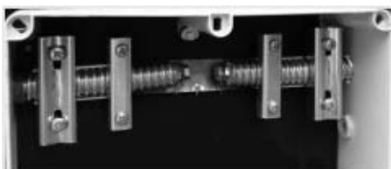
Obr. 2. Detail uchycení stínícího pláště smyčky MLA.
