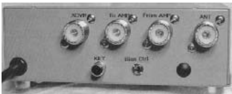
Obr. 4. Příklad uspořádání zadního panelu přepínače
