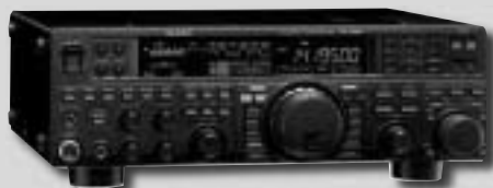
Yaesu FT-950 - TRX se špičkovou DSP technologií, 100 W, all mode, 160-6m
