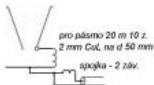
Obr. 10. CONE-DISK anténa
