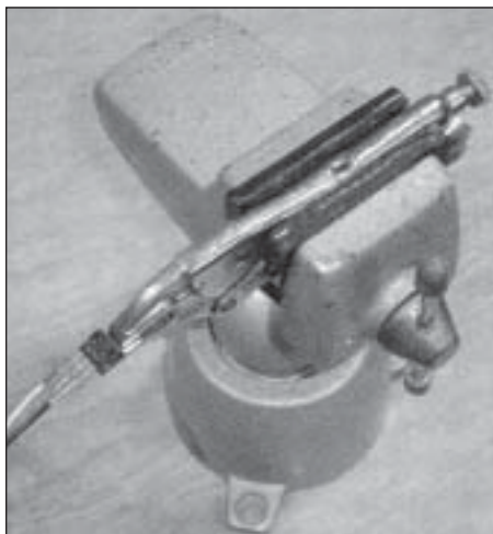
Obr. 2. Výkonový tranzistor rozptyluje výkon odpovídající součinu I_C \cdot V_{CE} , takže je nutné použít chladič. Improvizovaný chladič získáme použitím třeba většího peanu nebo kovového svěráčku.
