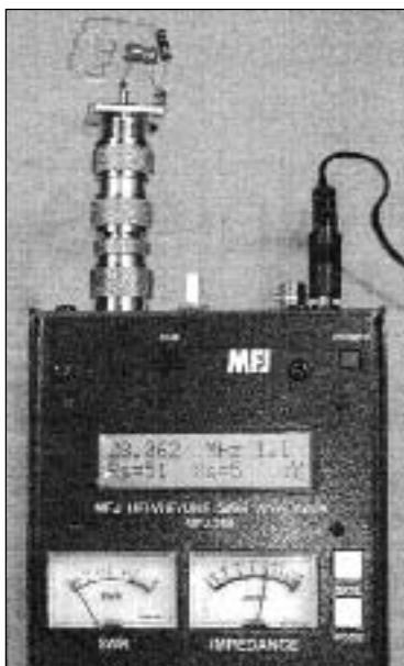
Obr. 3. Panelový konektor SO-239 může posloužit jako dobrá montážní základna pro experimenty s L-články. Na obrázku je vidět i anténní analyzátor, místo něho lze ale použít i vysílač s malým výkonem a můstek pro měření PSV.
