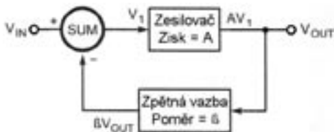
Obr. 1. Ideové blokové schéma popisuje oscilátor jako dvojici obvodů, z nichž jeden zajišťuje zesílení a druhý přivádí část výstupního signálu zpět na vstup.
