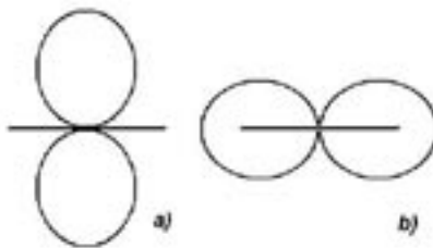
Obr. 1. Náčrt přijímacích charakteristik elektrického dipólu a rámu při pohledu shora (rám provozován kolmo k zemní rovině): a) elektrický dipól – maximální příjem kolmo na směr dipólu ( \varphi = 90^\circ ); b) magnetický rám – maximální příjem ve směru roviny rámu ( \varphi = 0 ).
