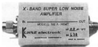
Obr. 1. Hotový moderní výborný nízkošumový zesilovač pro pásmo 10 GHz.
