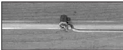
Obr. 8. Připojení a upevnění vodiče fázovacího vedení na hliníkovou trubku pomocí hadicové spony
