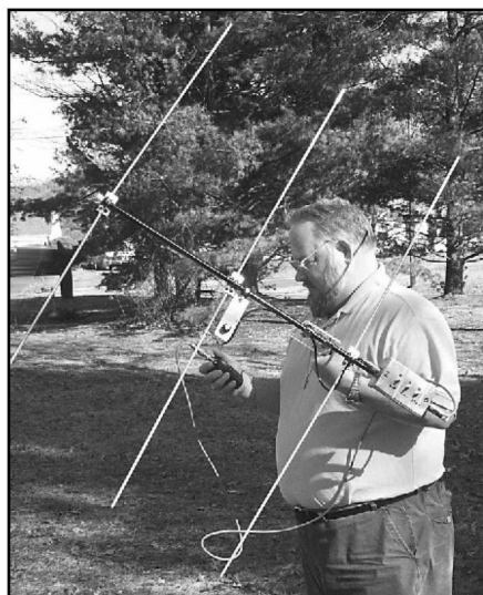
Bob Schelgen, KU7G, redaktor QST pro techniku, předvádí způsob zaměřování na VHF s 2m Yagi, řízeným atenuátorem a FM ručkou.
